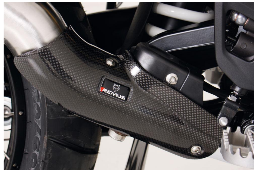
Carbon Hitzeschutzabdeckung / carbon heat protection shield
