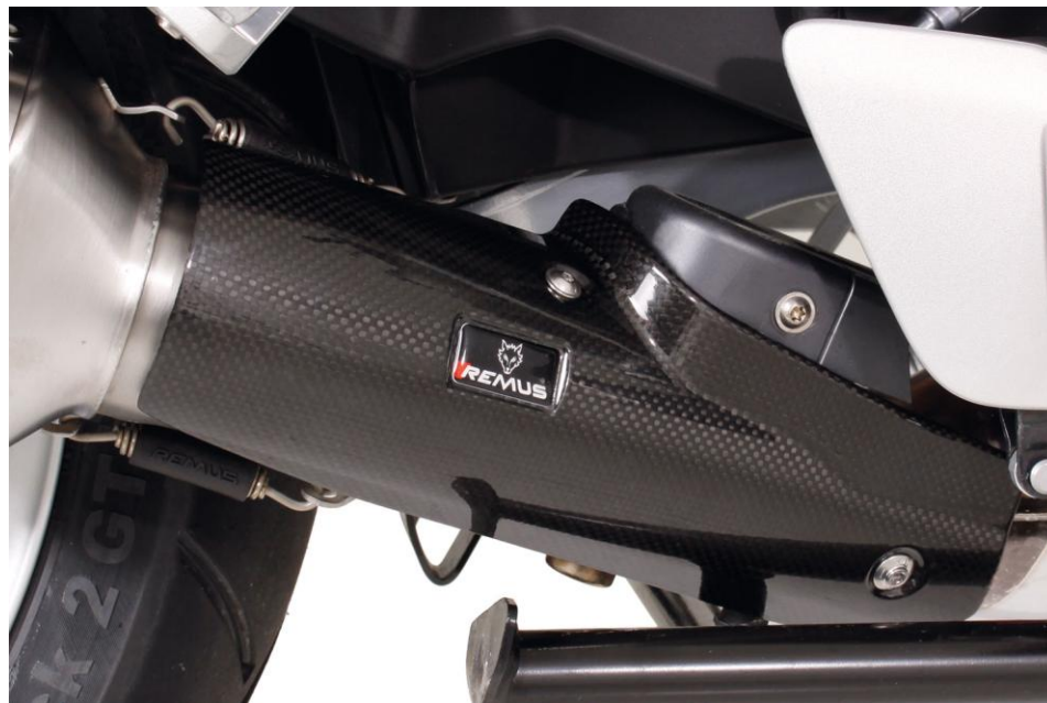
Carbon Hitzeschutzabdeckung / carbon heat protection shield
