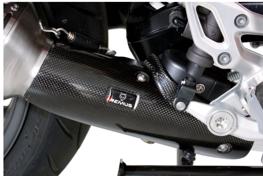
Carbon Hitzeschutzabdeckung / carbon heat protection shield
