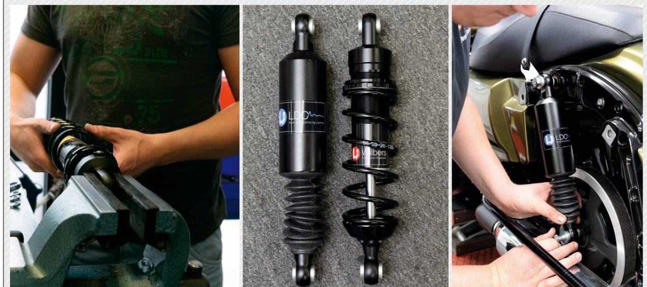
Der funktionale Grundkörper des Nivomaten (oben Mitte mit LDC-Schild) kommt als geschlossene Einheit von ZF Sachs
