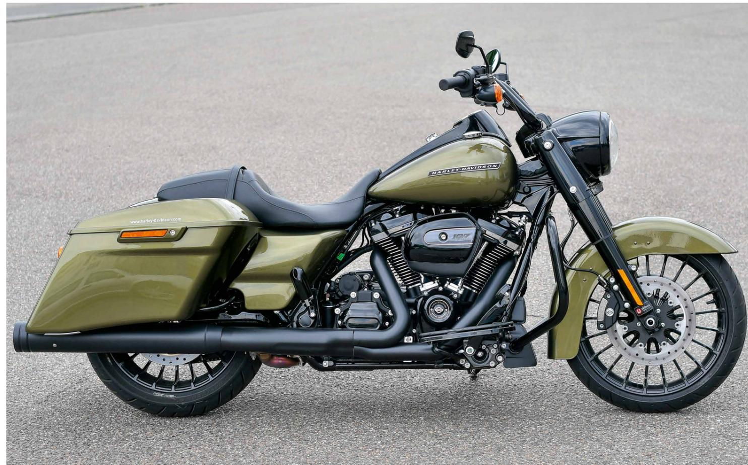
feren Federrate ein und spannten diese progressiv arbeitenden Federn mithilfe speziell gefertigter Vorspannhülsen dergestalt vor, dass genügend Negativfederweg generiert wurde. Zum Schluss gab's noch Wilbers-Öl mit einer anderen Viskosität in die Holme – die Sache war geritzt. Wieder
