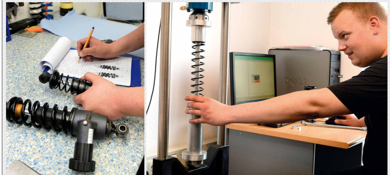
Oben zu sehen die originalen Harley-Federbeine. Diese wurden zerlegt und mit Spezialapparaturen vermessen
